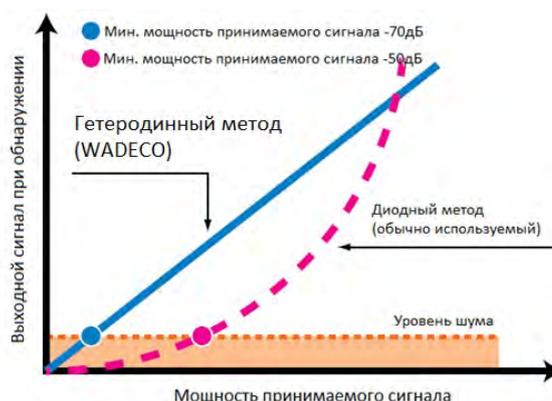
Выходной сигнал датчика при гетеродинном методе обнаружения пропорционален мощности принимаемого сигнала (**линейная** функция), в то время как при диодном методе выходной сигнал датчика пропорционален квадрату мощности принимаемого сигнала (**квадратичная** функция).
